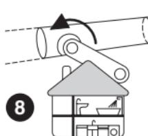
**PT** Cartucho com polifosfato em cristais: tratamento anti-calcário e proteção anti-corrosão de tubos, esquentadores, máquinas de lavar roupa, torneiras, duches. Duração: 6 meses. Manutenção: nenhuma. Temperatura máx 35°C. Dureza máx 500 ppm CaCO<sub>3</sub>. Utilizar um pré-filtro para proteger o cartucho.
